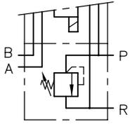
Одиночный соединительный блок с предохранительным клапаном<sup>1)</sup>
