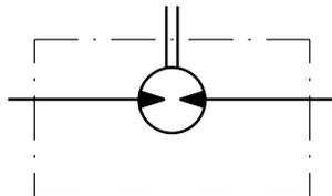
**MP/MR...U** моторы с уплотнением высокого давления с дренажом:
