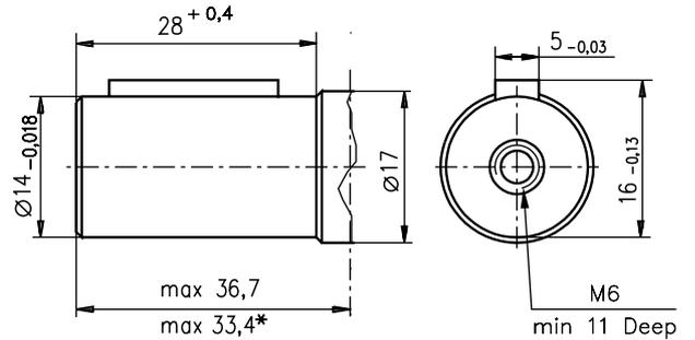
**SH** -  $\varnothing 16,5$  Splined, B17x14 DIN 5482
