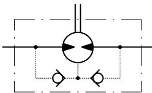
**MP/MR...** моторы с уплотнением вала низкого давления или стандартным с дренажом:
