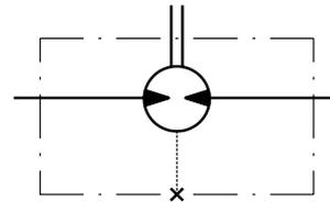
**MP/MR...I** моторы с уплотнением вала низкого давления или стандартным без дренажа:
