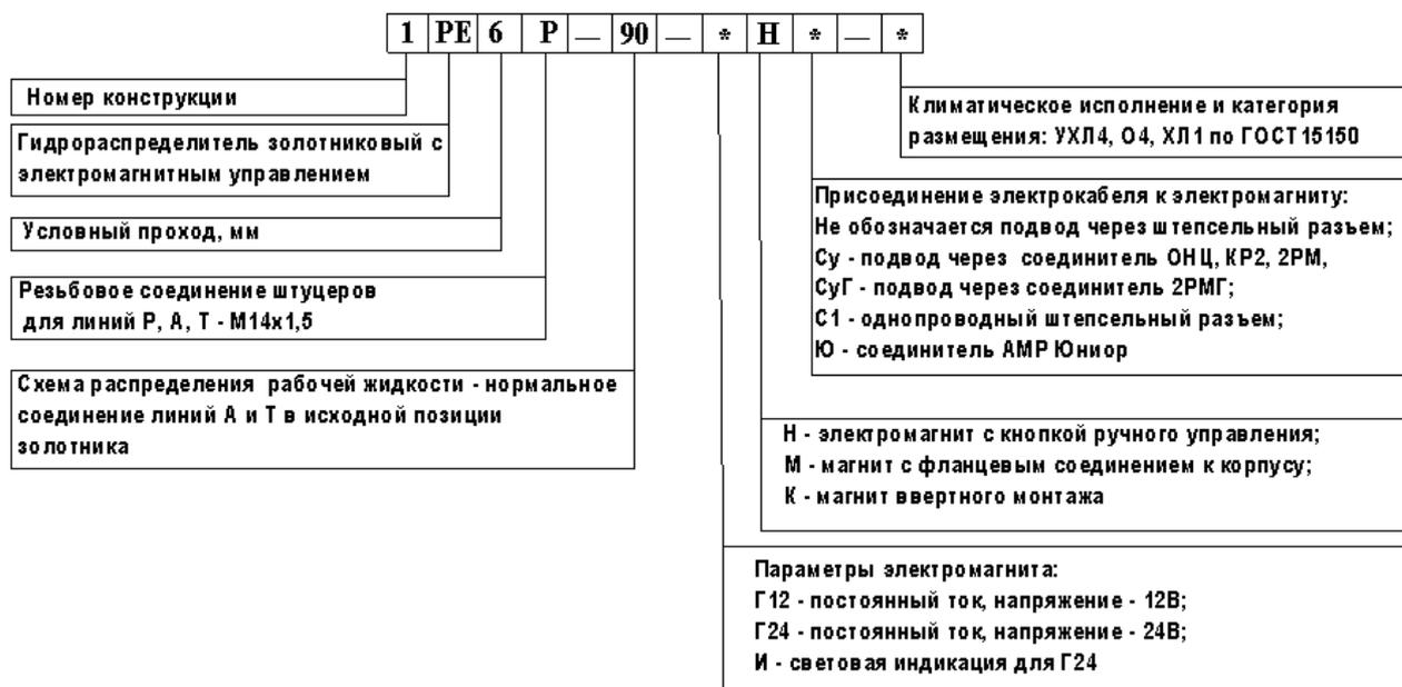
Условное графическое обозначение гидрораспределителя 1PE6P-90
