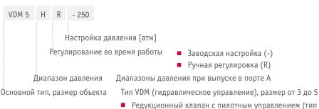
■ Редукционный клапан с пилотным управлением (тип VDX)
